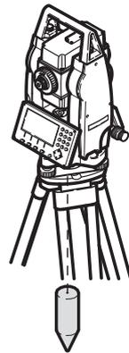
Dirección de la gravedad terrestre. El compensador define la línea de la plomada en el instrumento.
