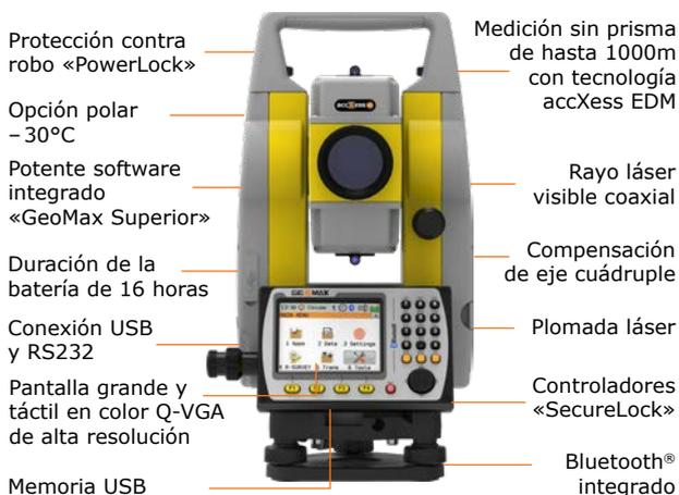
Con la tecnología accXess, de eficacia demostrada, el Zoom50 incorpora un motor de medición de distancias inteligente diseñado para lograr una velocidad y precisión sobresalientes incluso en condiciones duras. Un rango de medición más largo significa una cobertura operacional más amplia y menos tiempo perdido con los cambios de estación. El nuevo mecanismo de protección «PowerLock» impide que lo utilicen personas no autorizadas y reduce su atractivo para los ladrones.
