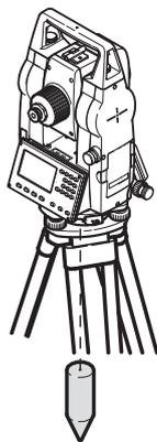
Dirección de la gravedad terrestre. El compensador define la línea de la plomada en el instrumento.
