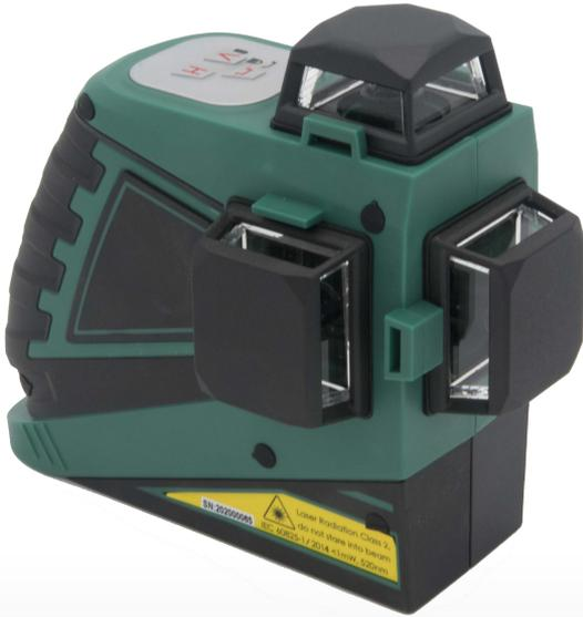
El nivel láser verde 360GS ofrecen la durabilidad y la precisión que cabe esperar para el mercado de la construcción. Nuestra nueva plataforma de nivelación láser ofrece una plataforma de bloqueo del péndulo para transportar el instrumento con seguridad. El péndulo autonivelante de rápida configuración le ofrece líneas de referencia.
